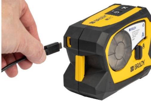
2. Inserte el otro extremo del cable USB-C al puerto USB-C del adaptador de CA.
